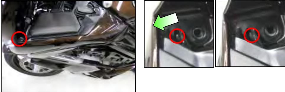
2. Tirer le carénage dans le sens de la flèche pour retirer les ergots.
