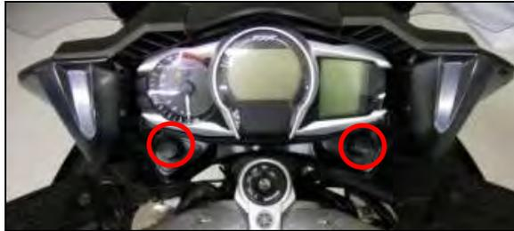
2. Déposer le cache intérieur du carénage avant. Le cache intérieur du carénage avant est fixé par des vis à tête hexagonale, des rivets et des ergots.
