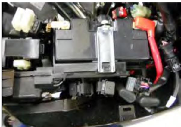
2. Déposer le flanc de carénage droit. (Se reporter à la page relative à la dépose du flanc de carénage droit) L'ECU se trouve à côté du boîtier de batterie.
