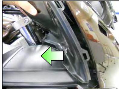
4. Décrocher les ergots en bas du cache intérieur du carénage avant des caches intérieurs supérieurs.
