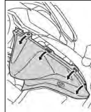
Les ergots en bas du cache intérieur du carénage avant sont illustrés ci-dessous.
