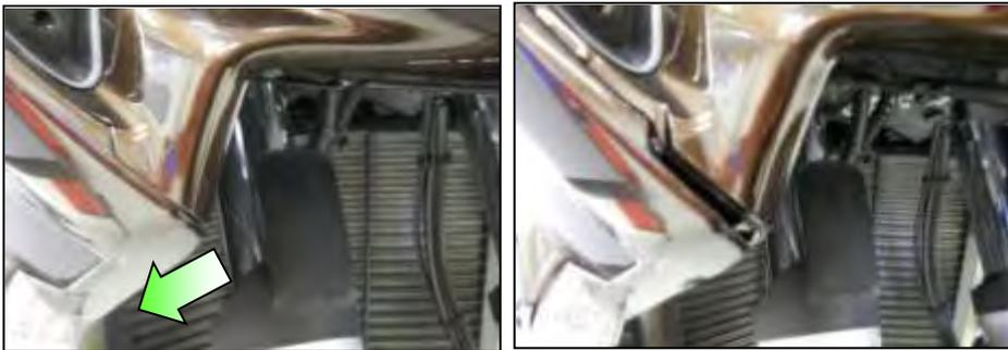
3. Tirer le carénage dans le sens de la flèche pour retirer les ergots.
