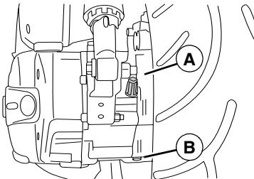
Der Getriebeölwechsel ist bei warmem Motor durchzuführen, damit das Öl leichter abläuft.
