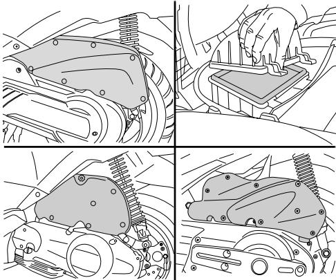
**Échanger l'élément filtrant<sup>2</sup>**
