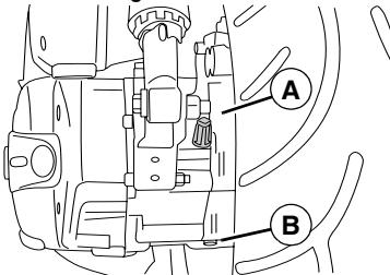
Olieskift på gearkassen bør foretages, når motoren er lunken for at lette afløbet af olien.
