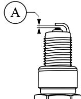
A. Elektrodenabstand: 0.7 bis 0.8 mm
