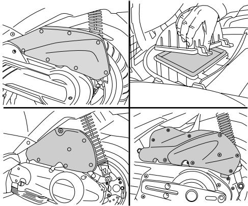
Sostituire l'elemento filtrante<sup>2</sup>
