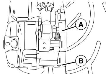
A mudança de óleo da caixa de transmissão distribuidora deve ser efectuada quando o motor está morno de forma a facilitar o escoamento.
