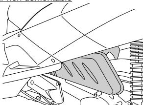
**Échanger le filtre complet.<sup>1</sup>****Filtre à air démontable**
