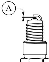
A. Afstand mellem elektroderne : 0.7 til 0.8 mm
