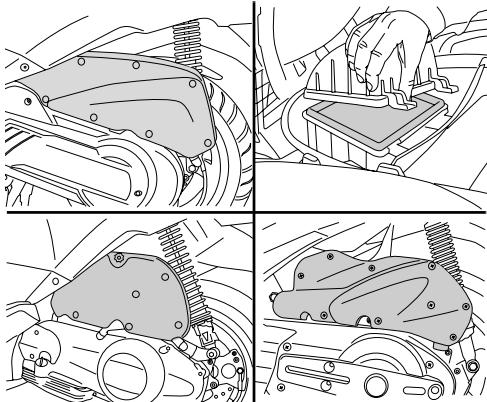
Udskift filterelementet <sup>2</sup>
